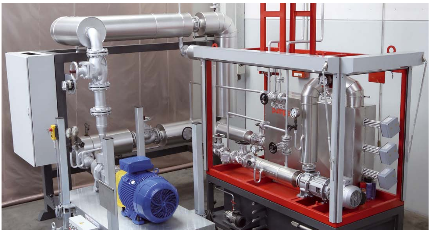
Banc d'essai d'huile thermique avec système de surveillance des pompes à l'usine de Speck à Roth. Étude de l'impact de températures élevées allant jusqu'à 350 °C sur la durée de vie des pompes.
